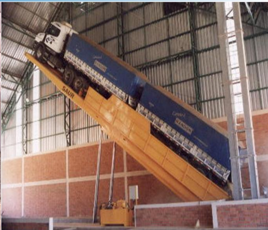
Plataforma de descarga (tombador)
