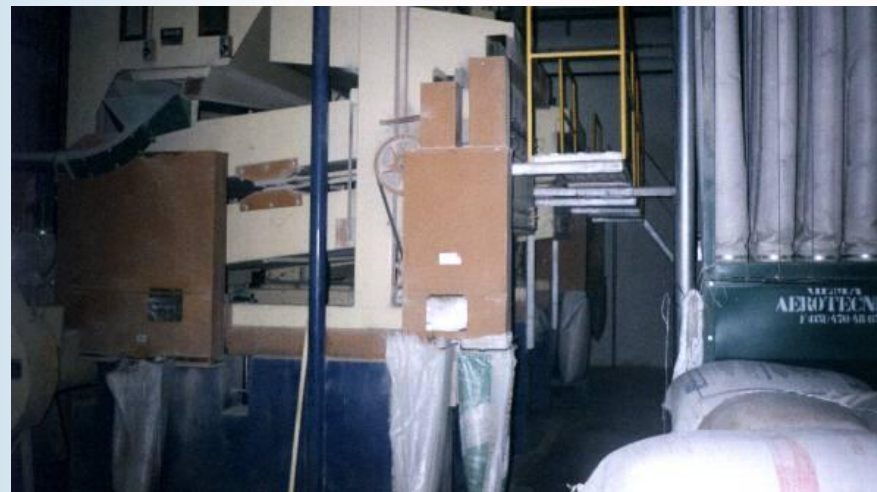
Máquina de ar e peneiras planas. Pode ser utilizada na pré-limpeza de grãos que chegam diretamente das lavouras e/ou na de limpeza/seleção
