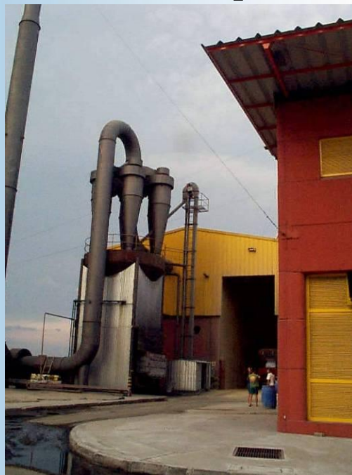
Máquina de ar e peneiras planas. Pode ser utilizada na pré-limpeza de grãos que chegam diretamente das lavouras e/ou na de limpeza/seleção
