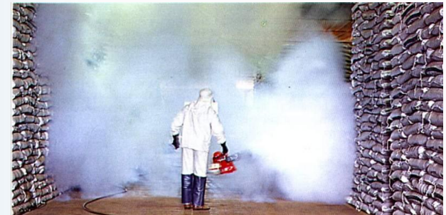
Tratamento protetor ou preventivo aplicação por termonebulização.
