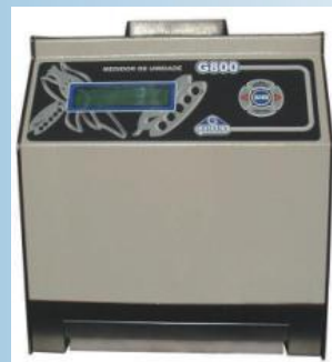
Medidor de umidade baseado em propriedades dielétricas dos grãos
