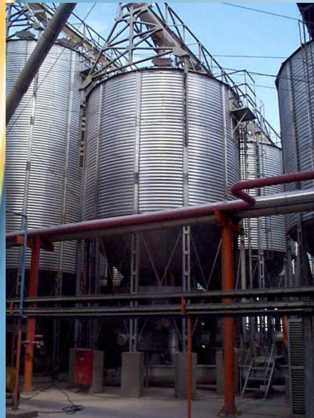
Reguladores de fluxo ou silo-pulmão de fundo cônico
