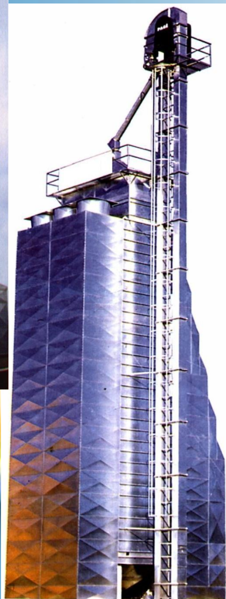
SECADOR DE COLUNA
